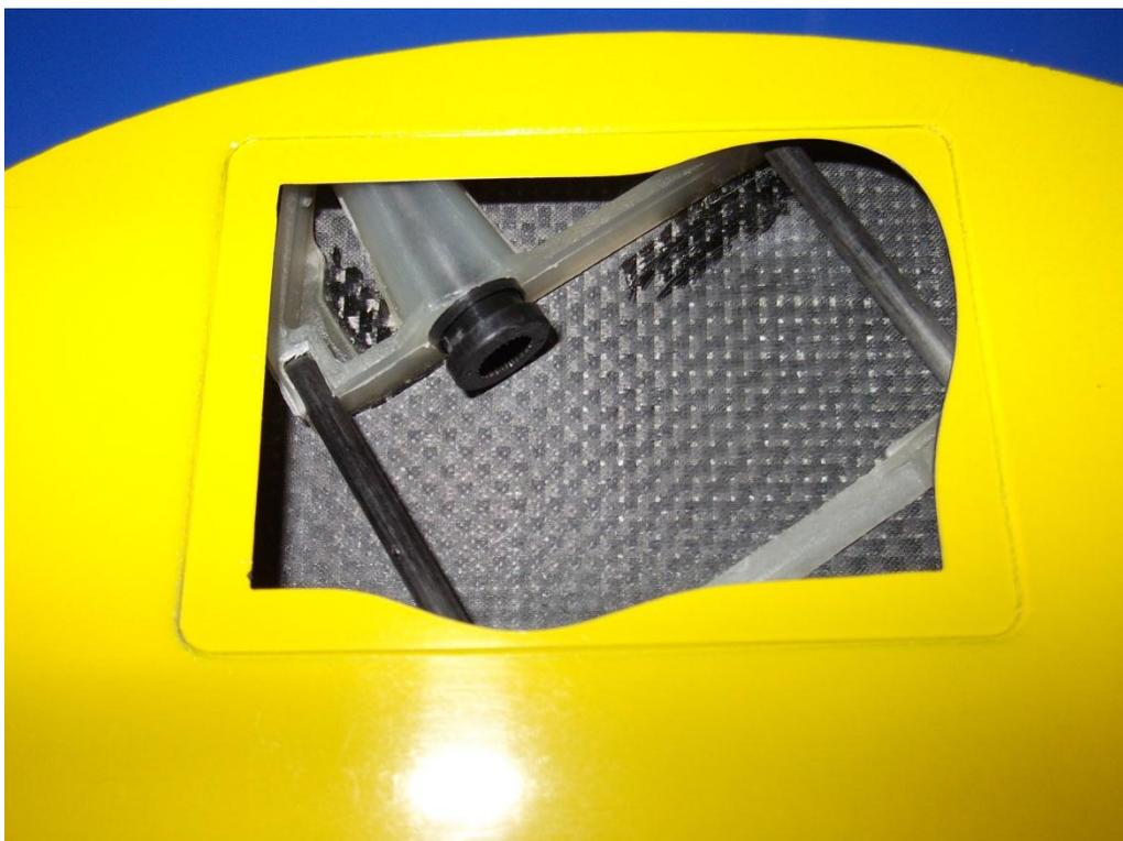
Die tatsächliche Verklebung erfolgt am besten mit angedicktem Epoxidharz in den dreieckförmigen Aussparungen des RDS Rahmens. Natürlich muss auch der hintere schmale Steg zur Aufnahme der Kohlestäbe gut mit der Schale verklebt werden.
